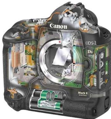
Contrairement à une caméra CCD, le capteur d'un appareil photo numérique n'est pas refroidi. En longue pose, il occasionne donc naturellement du bruit. Malgré tout, les fabricants maîtrisent très bien les CMOS et leur électronique, si bien que ce bruit reste discret, d'autant que la soustraction d'un dark et l'addition de plusieurs images réduisent ce bruit.
