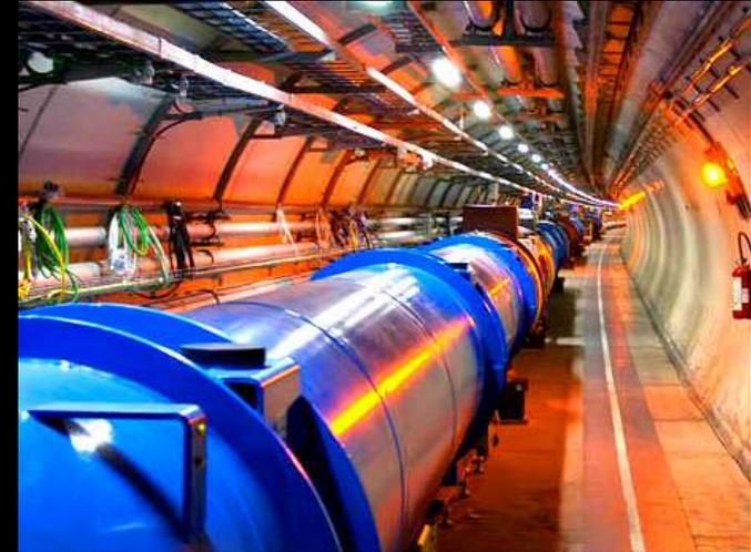
27 km de diamètre ; 100 m sous terre ; accélération de protons de très haute énergie et d'ions à une vitesse très proche de celle de la lumière., guidés par de puissants aimants supraconducteurs. Les détecteurs sont capables de voir jusqu'à 600 millions de collisions/s.
