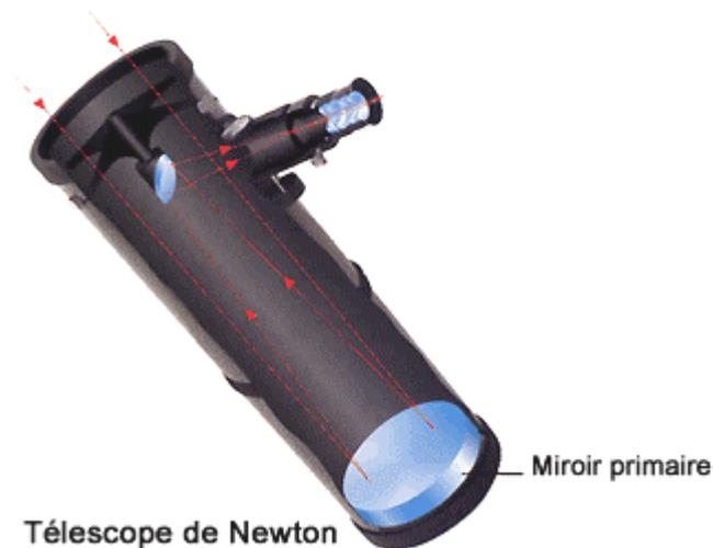
**Avantages** : Coût de fabrication peu élevé ce qui permet de réaliser des Newton en monture simple (les Dobson) pour un prix très compétitif. Obstruction peu importante par rapport aux autres types de télescopes. Rapport F/D polyvalent qui fait du Newton un télescope aussi bien adapté au planétaire qu'au ciel profond.
