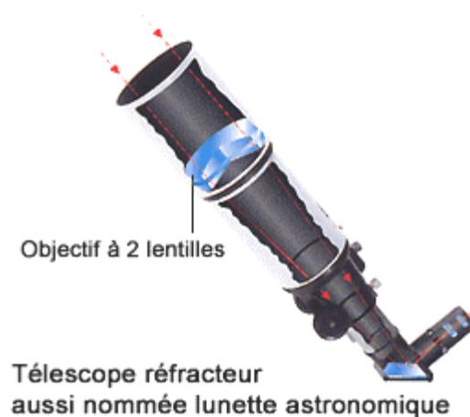
**Avantages** : prix peu élevé pour les petits diamètres (50 à 60 mm) ; encombrement et poids réduits. Pas d'obstruction et optique définitivement réglée en usine.
