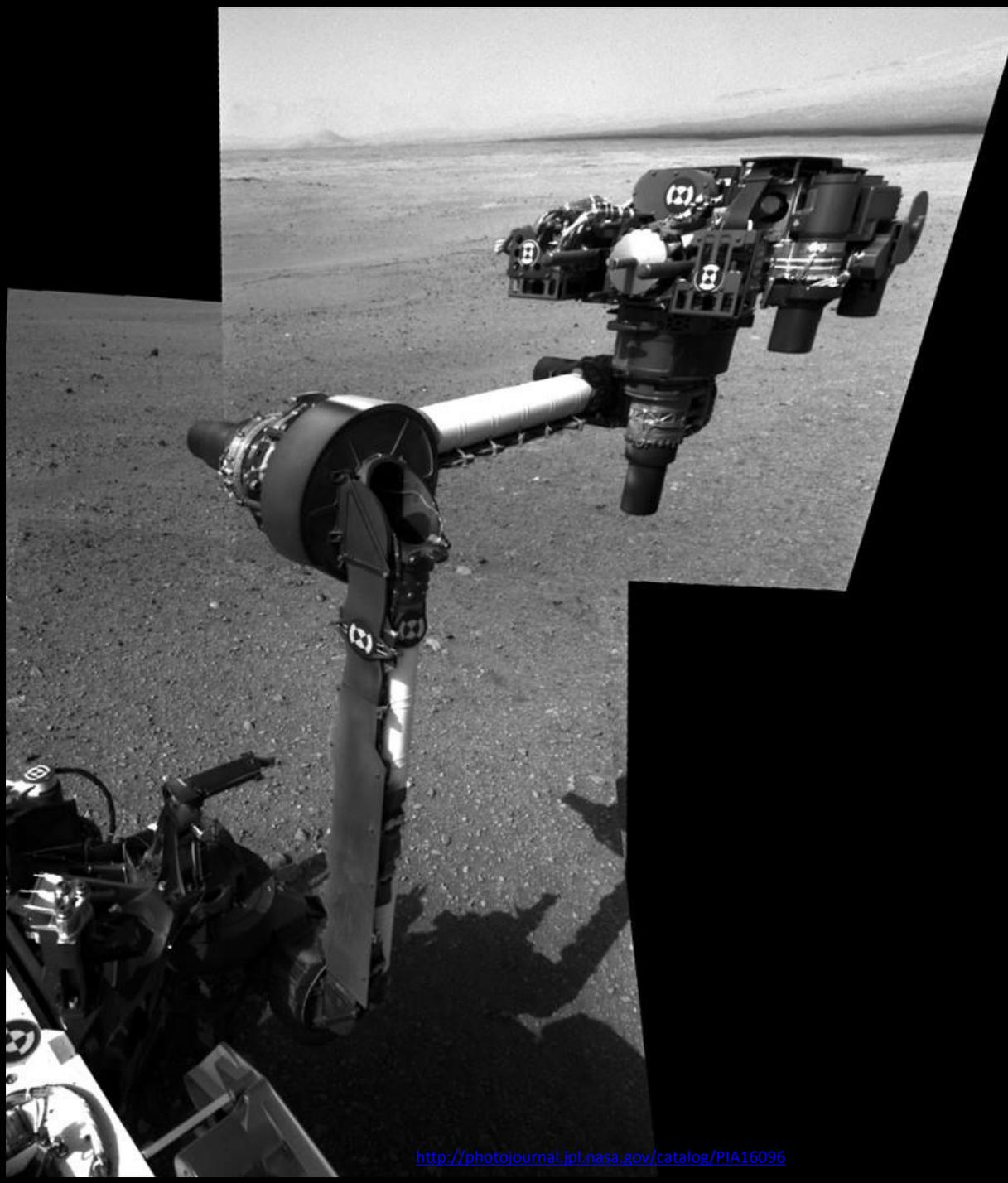
**Le bras porte-instruments a été sorti le 20 août 2012. La caméra « microscope » fonctionne (il s'est testé sur le rover lui-même). Il réserve mini forages, prélèvements, analyses ... pour quand ça vaudra le coup.**
